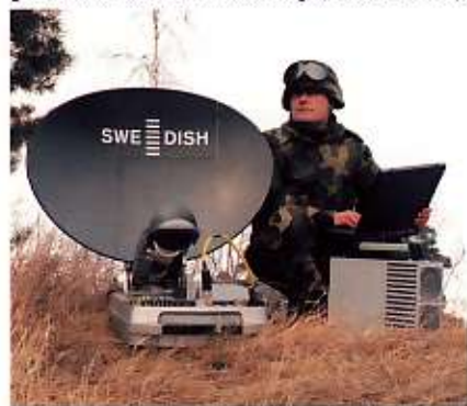
De 'Swe-dish', een volledig opvouwbare satellietantenne voor 'in het veld'.
